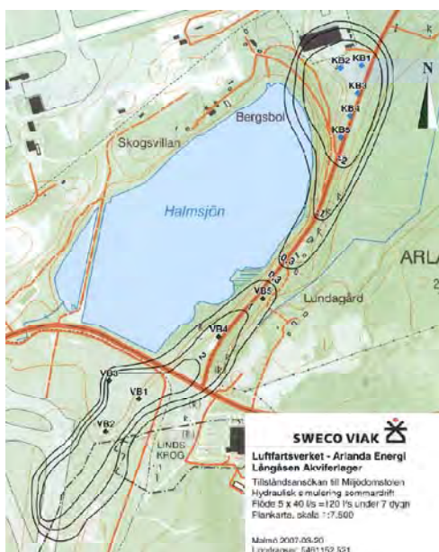
Figur 4 Planerade brunnslägen samt hydraulisk simulering av sommardriftfall för akvifervärmelager (sänkta nivåer i norr och höjda nivåer i syd) [18]. Såväl brunnslägen som grundvattennivåer kan avvika från verkliga.
